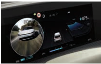
후측방 모니터 방향 지시등 스위치를 조작하면 해당 방향의 후측방 영상을 클러스터에 표시해 줍니다.
