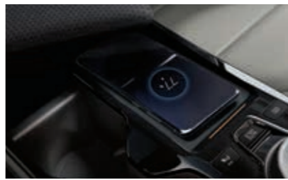
스마트폰 무선충전 시스템 센터콘솔 상단 트레이에 마련된 스마트폰 무선충전 시스템으로 스마트폰을 충전할 수 있습니다. ※ 스마트폰 기종에 따라 별도의 충전 패드 또는 충전 커버가 필요할 수 있으며, 별도 수신장치 장착 불가 기종은 이용이 어려울 수 있습니다.
