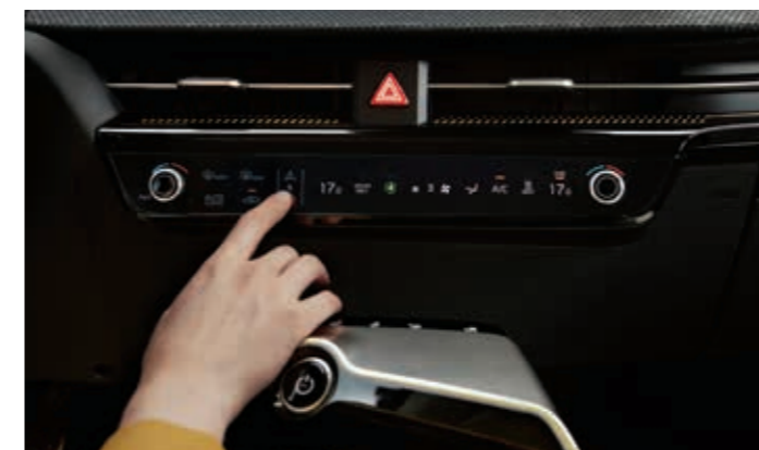
인포테인먼트 / 공조 전환 조작계 조작 패널 중앙의 버튼 하나로 인포테인먼트 주요 기능과 공조 시스템, 두 시스템을 쉽게 오가며 통합 컨트롤 할 수 있습니다. 더불어 직관적 조작이 필요한 버튼 외에 모든 버튼을 터치 방식으로 적용해 미래 모빌리티를 경험할 수 있게 하였습니다.
