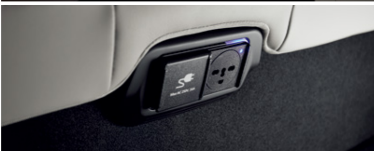
실내 V2L 콘센트 2열 시트 하단에 위치한 콘센트를 통해 220V 전원을 연결, 차량 내부에서 다양한 전자기기를 편리하게 사용할 수 있습니다.
