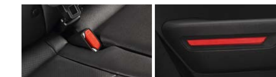
2열 시트벨트 버클 조명 (택시 모델 限) / 2열 도어 리플렉터 시트벨트 버클 주변 LED 조명으로 시인성을 높여 탑승자의 벨트 체결에 도움을 주고, 2열 도어 암레스트에 적용된 리플렉터가 탑승객의 안전한 승하차를 보조합니다.
