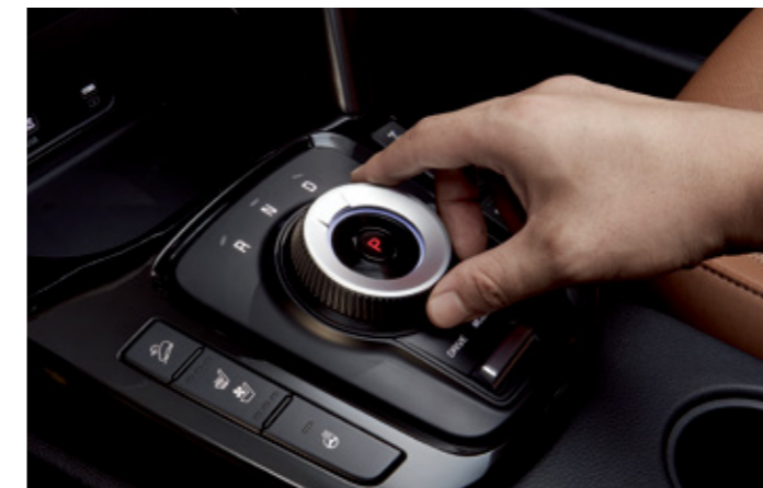
전자식 변속 다이얼 정교한 디테일이 돋보이는 다이얼 타입 전자식 변속기를 적용하여 편안한 그립감과 고급감을 동시에 제공합니다.
