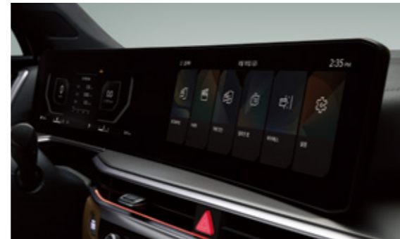
슈퍼비전 클러스터 (12.3인치 풀사이즈 칼라 TFT LCD)
