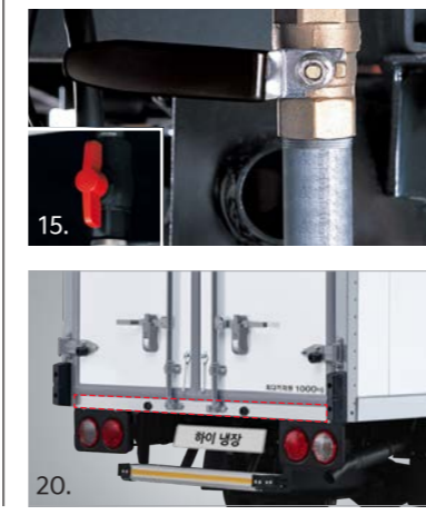
11. 복합구조 사이드/리어도어 판넬* 12. 사이드 슬라이딩도어* 13. 사이드 스윙도어* 14. 리어 트윈 스윙도어* 15. 드레인 밸브 16. 고압축 목재바닥 17. 후방 주차거리 경고* 18. 실내등 19. 비상벨 20. 리어도어 프레임 스테인리스 커버*
